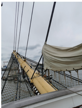
Der Bugspriet ragte weit über die Bordwand, um den Masten guten Halt zu geben
