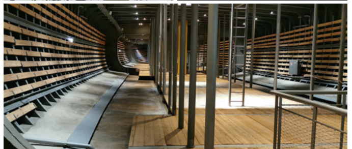
Ungeteilter Laderaum mit Schwitzbeplankung, damit die Ladung nicht feucht wurde
