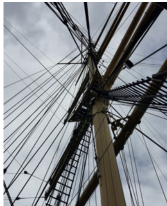
Großmast (Höhe 54 Meter über Wasserlinie) und Takelage
